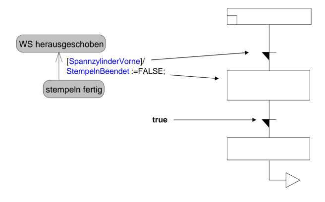
Abbildung von Aktionen mit Hilfe eines Zwischenzustandes
