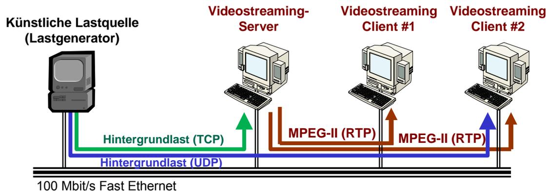
Ein mögliches Einsatzszenario: Untersuchung der Videostreaming-Qualität bei verschiedenen Hintergrundlasten
